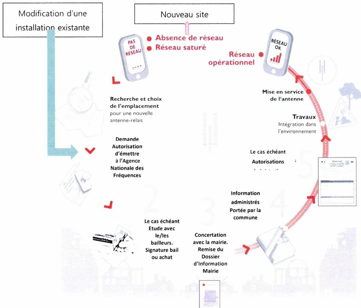
Pour permettre à ses clients de disposer de services de téléphonie mobile innovant et de qualité, il est nécessaire, pour un opérateur de téléphonie mobile, d'anticiper les besoins d'aujourd'hui et de demain des utilisateurs. Le réseau doit être en mesure d'assurer une couverture de qualité et d'évoluer au rythme des utilisations de la populatio
